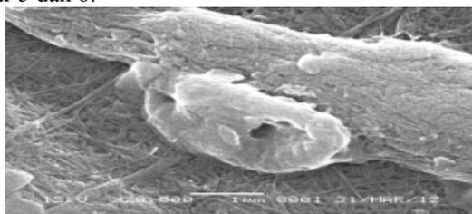
Gambar 5. Hasil foto SEM (*scanning electron microscope*) lembaran plastik *nata de manihot* tanpa penambahan gliserol
